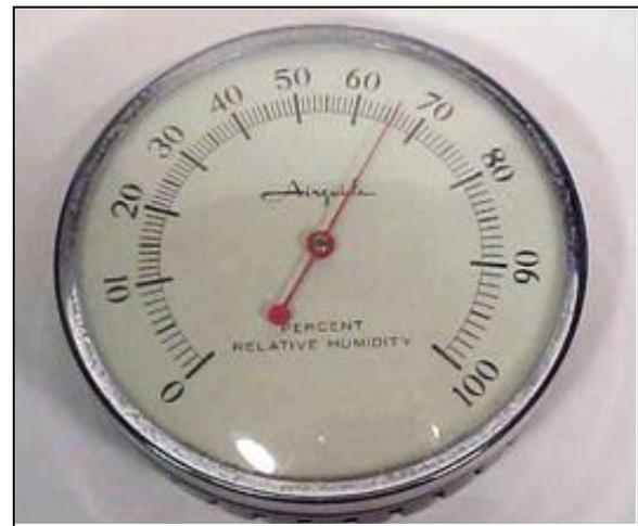
**Figura 10.** Higrómetro AIRGUIDE.
